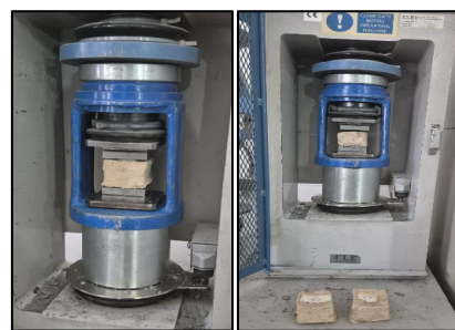
شکل ۱۶: جک ملات شکن جهت بررسی مقاومت فشاری نمونه ها
