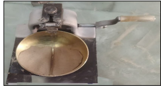
شکل ۶: تعیین حد روانی نمونه ها (آزمایشگاه خاک و مکانیک استان اصفهان، ۱۴۰۳)
