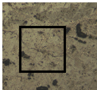
شکل ۲۱. وجود فریت صفحه‌ای نامنظم (بزرگنمایی ۱۰۰ برابر)
