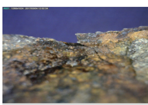
شکل ۱۵. شیارهای موجود در سطح Figure 15. Grooves on the surface
