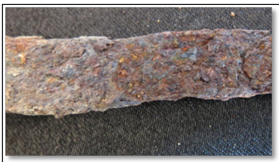
شکل ۱۰. رسوبات پودری نارنجی و زرد رنگ
