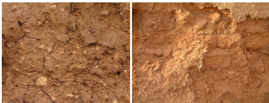
شکل ۴: خشت‌های ناهمگن و همراه با خرده آجر
