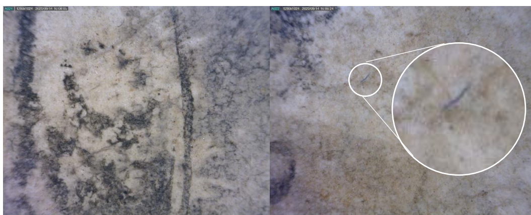
شکل ۱: تصاویر سطحی از کاغذ تاریخی (بزرگنمایی 180 \times ، گرفته شده توسط میکروسکوپ نوری دستی (Dino-lite).
