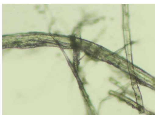
شکل ۲: تصویر میکروسکوپی الیاف اوراق نسخه خطی - بزرگنمایی 200 \times .
