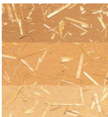
شکل ۴: تنوع رنگ خاک در پوشش مقاوم کاهگلی ضد آب
