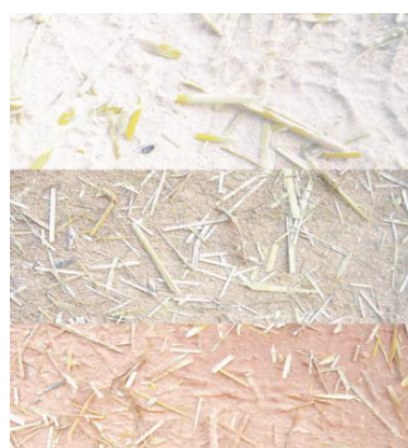
شکل ۴: تنوع رنگ خاک در پوشش مقاوم کاهگلی ضد آب
