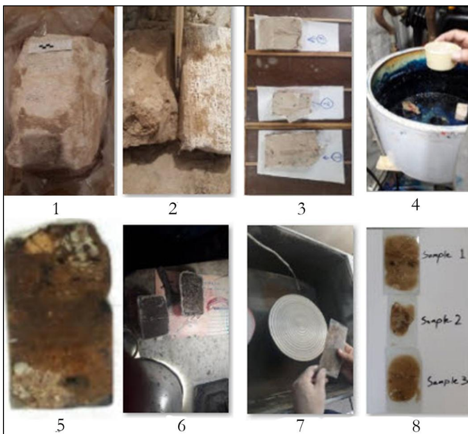
شکل ۳: مراحل تهیه‌سازی مقاطع نازک Fig.3: Thin Section Preparation stages
