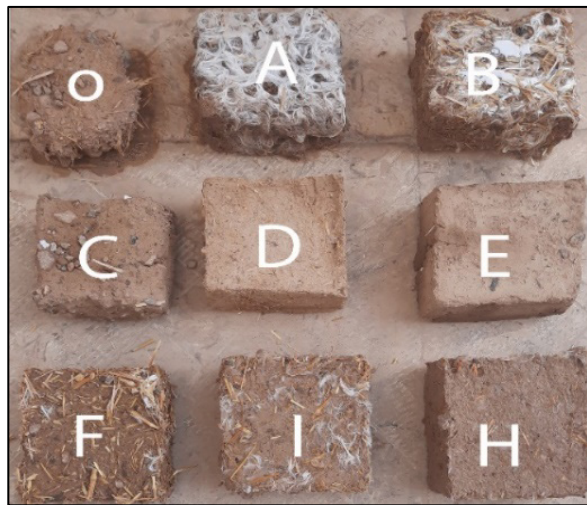
شکل ۱۰: نمونه ها بعد از انجام آزمایش آبشویی
