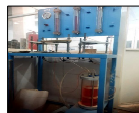
شکل ۱۹: آزمایش نفوذ پذیری خشت اولیه
