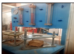
شکل ۱۷: آزمایش نفوذ پذیری نمونه D
