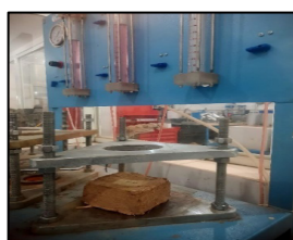
شکل ۱۸: آزمایش نفوذ پذیری نمونه H
