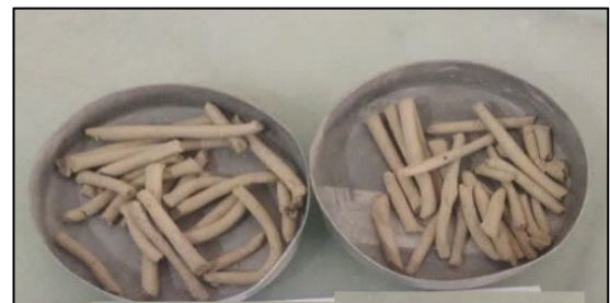
شکل ۷: تعیین حد خمیری نمونه ها (آزمایشگاه خاک و مکانیک استان اصفهان، ۱۴۰۳)
