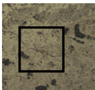
شکل ۲۱. وجود فریت صفحه‌ای نامنظم (بزرگنمایی ۱۰۰ برابر)
