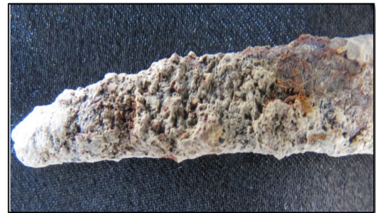
شکل ۸. خوردگی به شکل حفره
