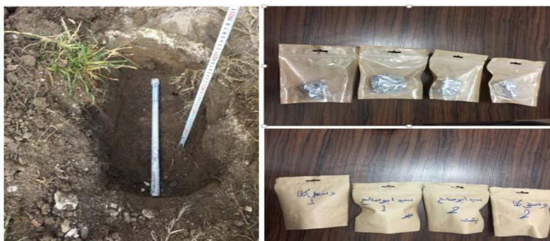
شکل ۴. تصاویر دفن دزیتر نمونه‌های تهیه‌شده از آجرهای پی سقانه‌ها.
