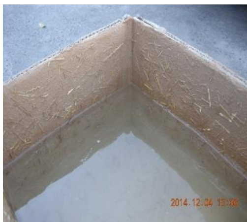
شکل ۵: نفوذناپذیری در برابر تماس رطوبت پوشش مقاوم کاهگلی ضد آب بر روی سطح کارتن مقوایی
